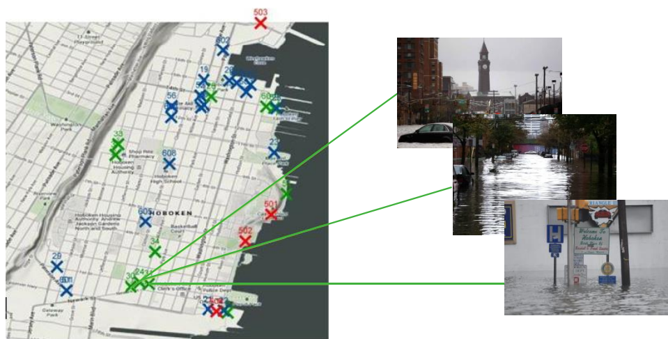
Figura 3-3: Crowdsourcing para validar el modelo de inundaciones. Junto con el Estado, el Stevens Institute of Technology explora técnicas innovadoras para juntar datos para el análisis de riesgo. Esta fotografía es una de muchas tomadas durante y después del embate del huracán Sandy mediante “crowdsourcing”. Las fotografías con identificación de tiempo y coordenadas geográficas, tal como ésta, permiten que el Estado valide las proyecciones del modelo comparándolas con puntos de datos documentados, refinando aún más la precisión del modelado de la inundación para identificar áreas de mayor vulnerabilidad ante las inundaciones.
